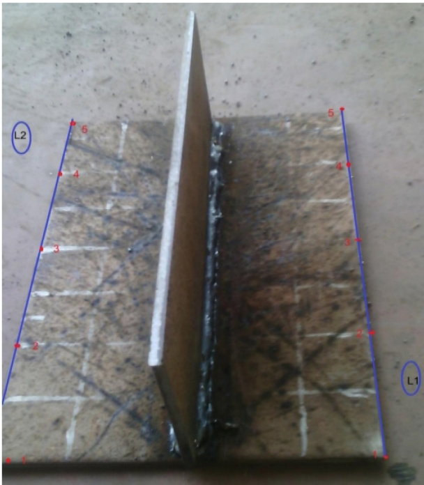
شکل 2- ورق بعد از انجام جوشکاری
