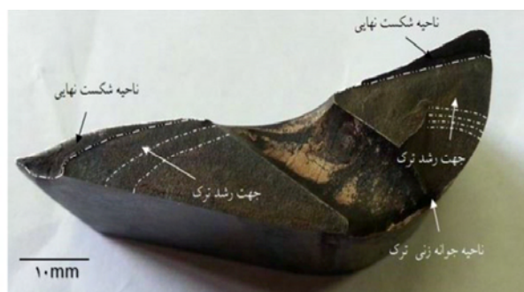
شکل ۳- تصویر ماکروسکوپی سطح شکست و وجود سه ناحیه جوانه زنی ترک، رشد ترک و شکست نهایی.
