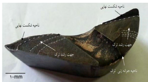
شکل 3- تصویر ماکروسکوپی سطح شکست و وجود سه ناحیه جوانه زنی ترک، رشد ترک و شکست نهایی.
