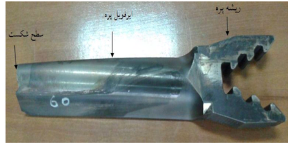
شکل 1- پره شکسته شده
