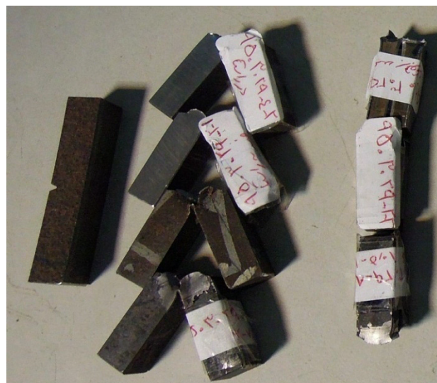
شکل ۱۹- سطح مقطع شکست نمونه‌های آزمون ضربه
