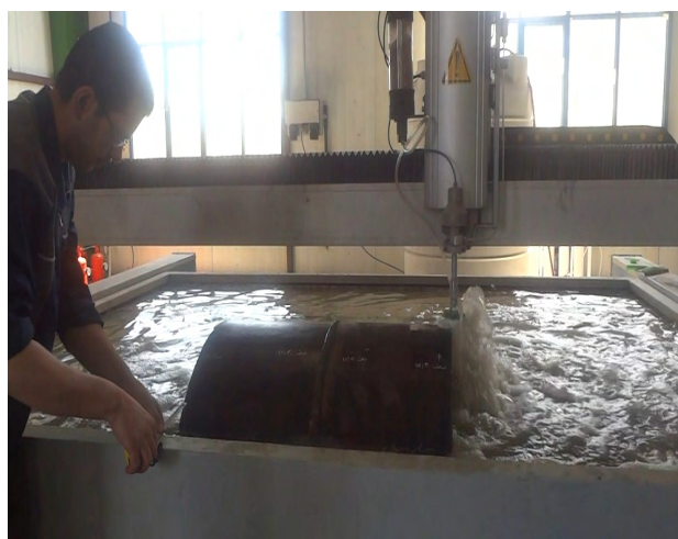
شکل ۶- برشکاری لوله توسط واترجت
