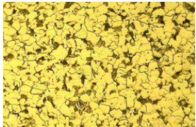
شکل ۱۵- تصاویر میکروسکوپی پاس گرم
