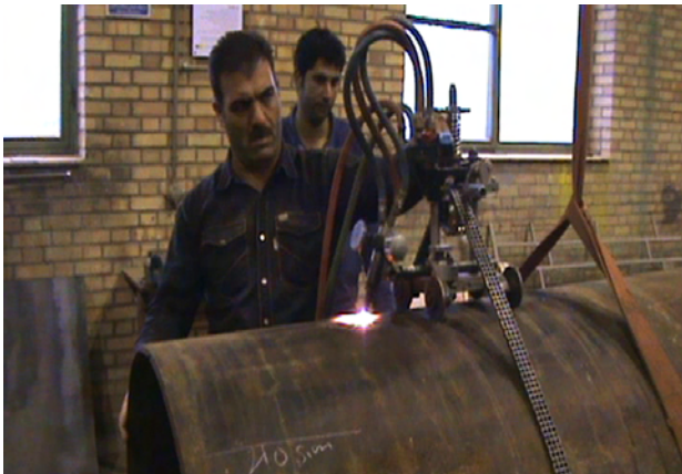
شکل ۱- برش کاری لوله
