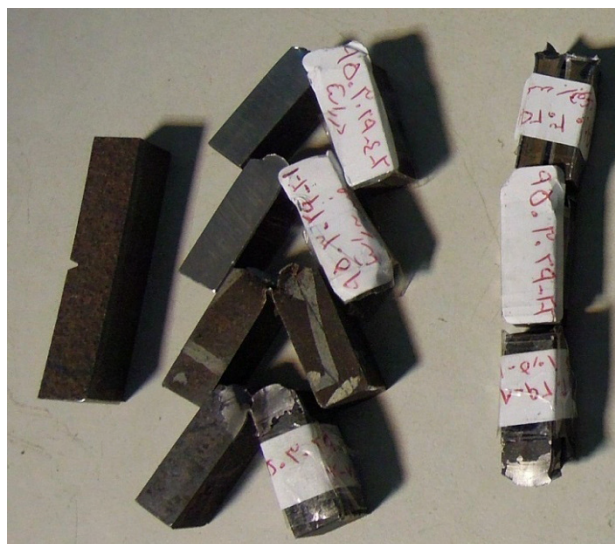
شکل ۱۹- سطح مقطع شکست نمونه‌های آزمون ضربه
