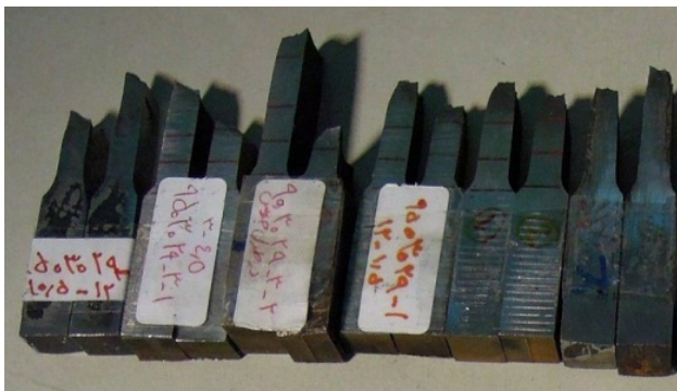
شکل ۱۸- سطح مقطع شکست نمونه‌ها
