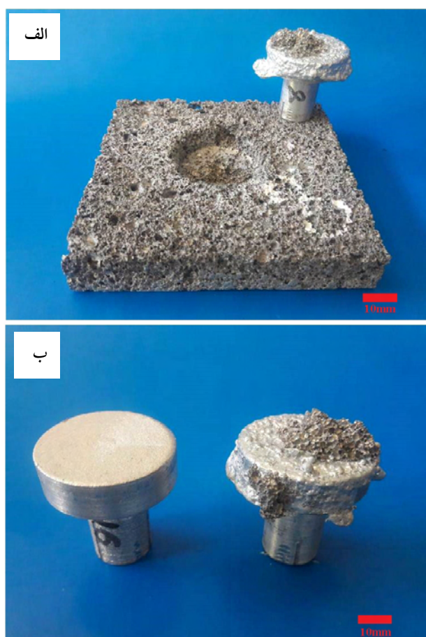
شکل ۳-الف) ابزار چرخش و فوم آلومینیومی بعد از آزمون کشش، ب) سطح صفحه آلومینیوم بعد و قبل از لحیم کاری.
