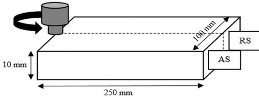
شکل 1- طرح‌واره‌ای از فرایند جوشکاری اصطکاکی اغتشاشی
