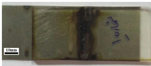
شکل ۶ - نمونه های جوشکاری St12 و پلی کربنات
