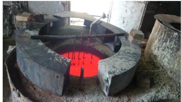
شکل 4- عملیات حرارتی نمونه ها در کوره
