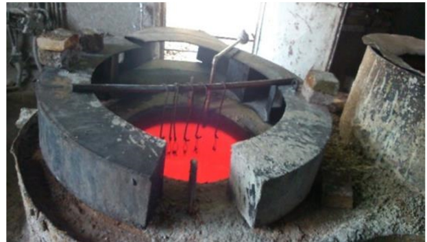
شکل 4- عملیات حرارتی نمونه ها در کوره
