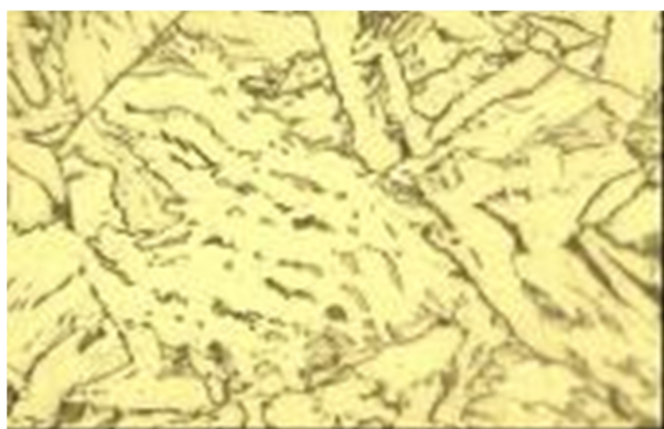
شکل 15- تصاویر میکروسکوپی پاس سطح
