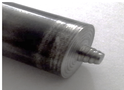
شکل ۲- ابزار طراحی شده جهت جوشکاری اصطکاکی اغتشاشی
