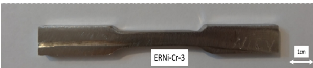
شکل ۲- نمونه‌های مربوط به آزمایش کشش تهیه شده از نمونه‌های جوشکاری شده با فلزات پرکننده مختلف.
