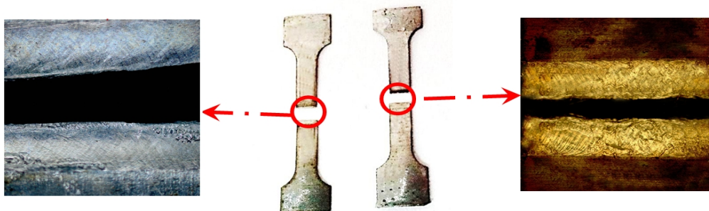
شکل ۴- تصاویر نمونه های آزمون کشش مربوط به نمونه های جوش داده شده توسط پرتوهای پرنرژی
