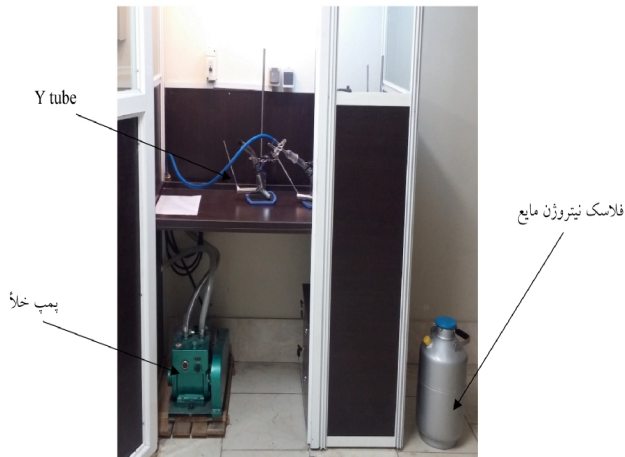
شکل 1- شمایی از مونتاژ تهیه شده برای انجام آزمایش اندازه‌گیری هیدروژن جوش
