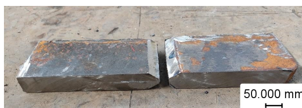
شکل 4- قطعات آماده‌سازی‌شده برای انجام فرایند جوشکاری مطابق با استاندارد AWS D1.1.
