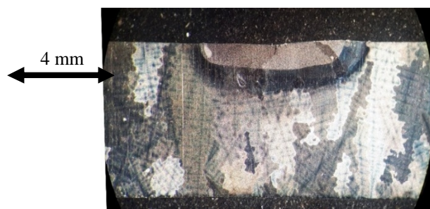
شکل 12- ساختار ماکروسکوپی منطقه جوش با شدت جریان 100 آمپر با زمان عملیات حرارتی یک دقیقه.
