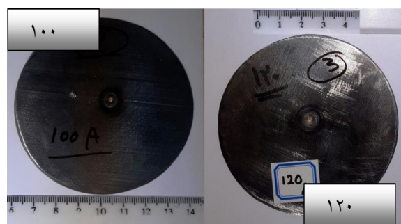
شکل 5- نمونه های جوشکاری شده با شدت جریان های 100 و 120 آمپر.
