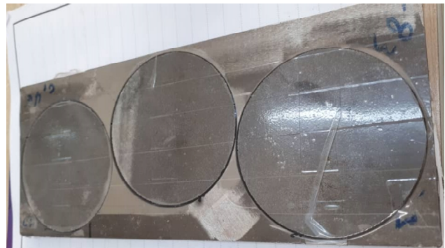
شکل 2- نمونه های دیسکی شکل مورد استفاده در عملیات حرارتی قوسی به قطر 80 میلی متر.
