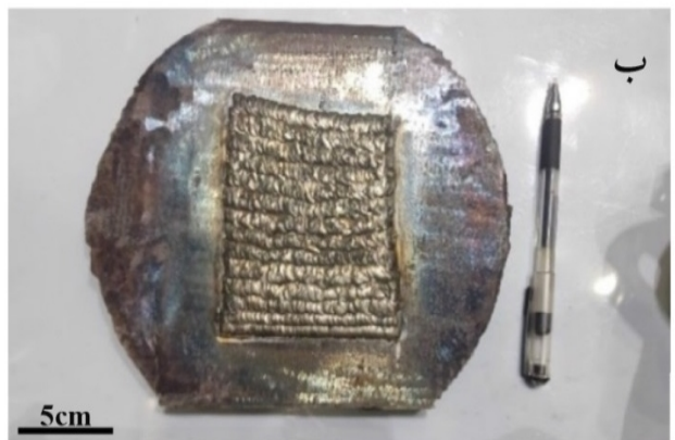
شکل 2- وضع ظاهری روکش‌های ایجاد شده: الف - اعمال پوشش کلمونوی به روش قوس تنگستن ب- اعمال پوشش کلمونوی به روش قوس پلاسما
