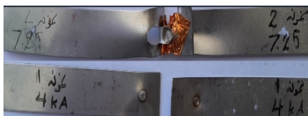
شکل 6- حالت شکست در نمونه‌ها: تصویر بالا شکست محیطی، تصویر پایین شکست فصل مشترکی.
