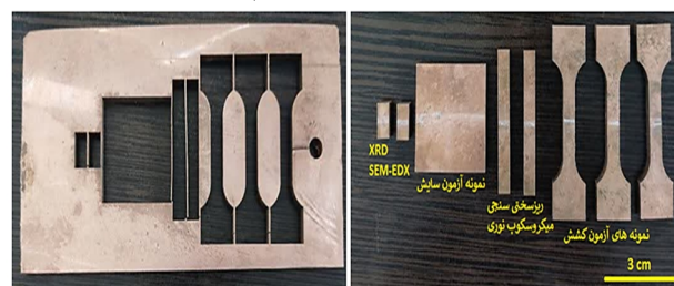
شکل 3- تهیه نمونه‌های استاندارد از کامپوزیت Cu-Ag-SiC
