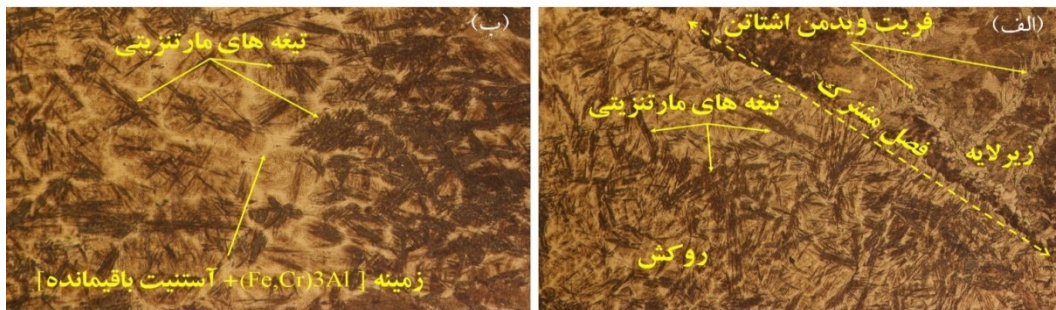
شکل 8- ریزساختار لایه روکش (Fe,Cr)_3Al (الف) ریزساختار فصل مشترک روکش/ زیرلایه و (ب) ریزساختار لایه روکش (Fe,Cr)_3Al
