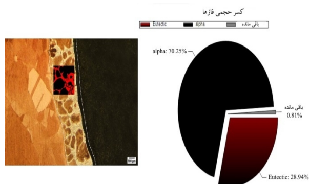
شکل 5- کسر حجمی فاز یوتکتیک و فاز اولیه \alpha اتصال با فلز پرکننده Ag-Cu-Ti-Sn با استفاده از نرم افزار Mip.
