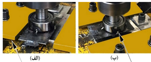
شکل 2- نحوه استفاده از پایه فلزی و نگه‌دارنده جهت جوشکاری نمونه‌ها از زوایای مختلف.
