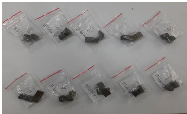
شکل 2- تصویر نمونه های جوشکاری شده بعد از وایرکات.
