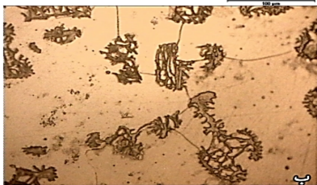
شکل 1- ریزساختار فلزات پایه (الف) سوپرآلیاژ (در دمای 1170^{\circ}\text{C} به مدت 30 دقیقه آنیل و در آب کوئنچ شده) (ب) ترکیب بین فلزی \text{Ni}_3\text{Al} .
