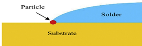
شکل 5- شماتیک محل قرارگرفتن نانو ذرات حین لحیم‌کاری [5].
