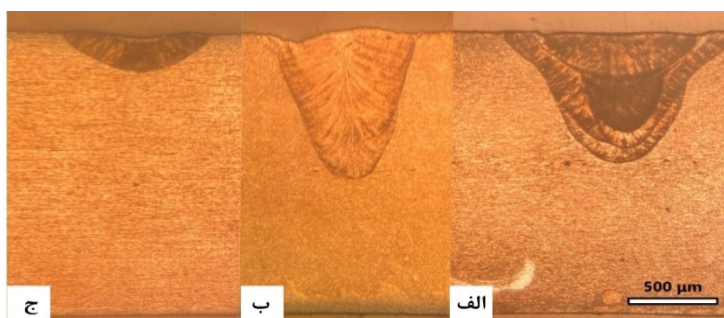
شکل 5- تصاویر متالوگرافی نمونه‌های به ترتیب با الف - R_a = 0,05 ب - R_a = 0,16 و ج - R_a = 0,57 میکرومتر با بزرگنمایی پنج برابر.
