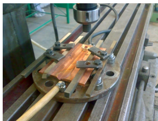
شکل 1- قالب جوشکاری مجهز به سیستم خنک کننده.
