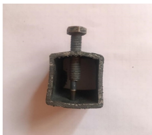
شکل 2- نحوه قرارگیری نمونه ها در فیکسچر
