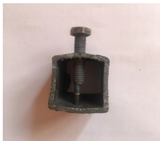
شکل 2- نحوه قرارگیری نمونه‌ها در فیکسچر
