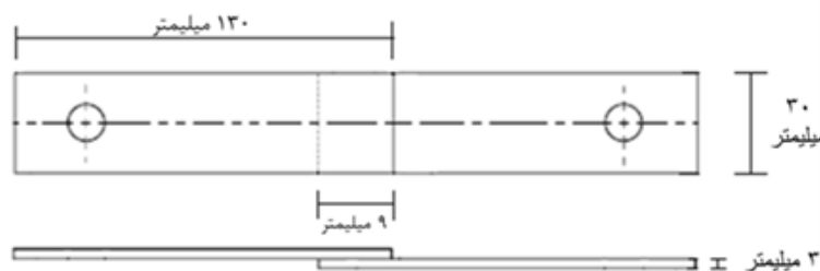
شکل 1- ابعاد قطعه برای انجام جوشکاری طبق استاندارد AWS C3.
