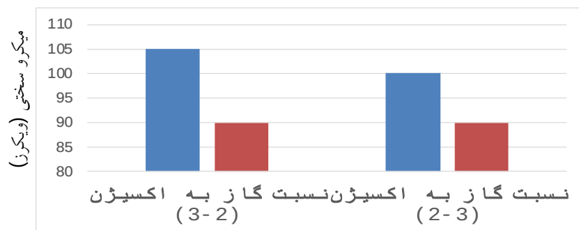
شکل 3- تاثیر نسبت گاز به اکسیژن بر میکرو سختی مرکز جوش با پرکننده‌های Cu-P و Cu-Ag-P
