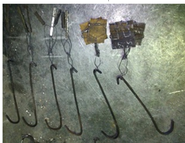
شکل 3- نمونه های کربوره کردن
