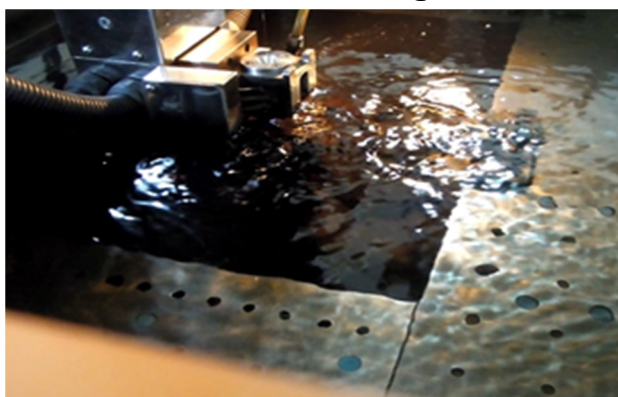
شکل 1- برشکاری با استفاده از دستگاه واترجت
