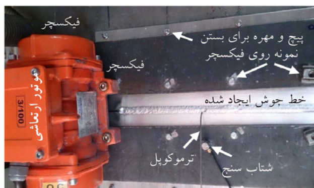
شکل ۱- وضعیت قرارگیری نمونه ها و موتور ارتعاشی جهت جوشکاری
