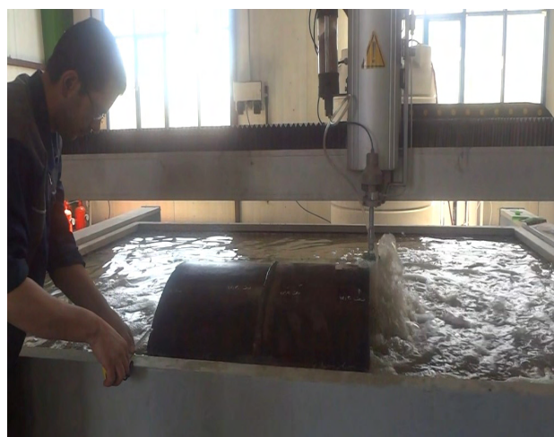
شکل ۶- برشکاری لوله توسط واترجت
