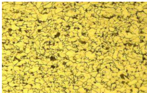
شکل ۱۶- تصاویر میکروسکوپی پاس پرکن
