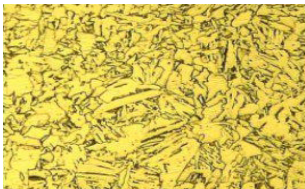
شکل ۱۷- تصاویر میکروسکوپی پاس سطح
