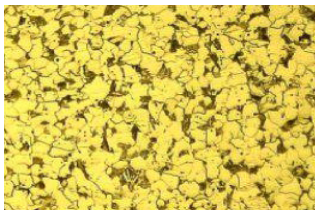
شکل ۱۵- تصاویر میکروسکوپی پاس گرم
