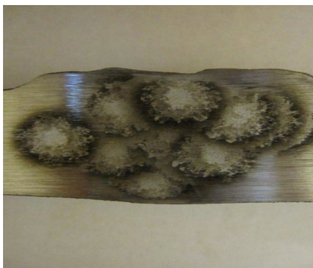
شکل ۸- نمونه های آزمون کوانتومتری
