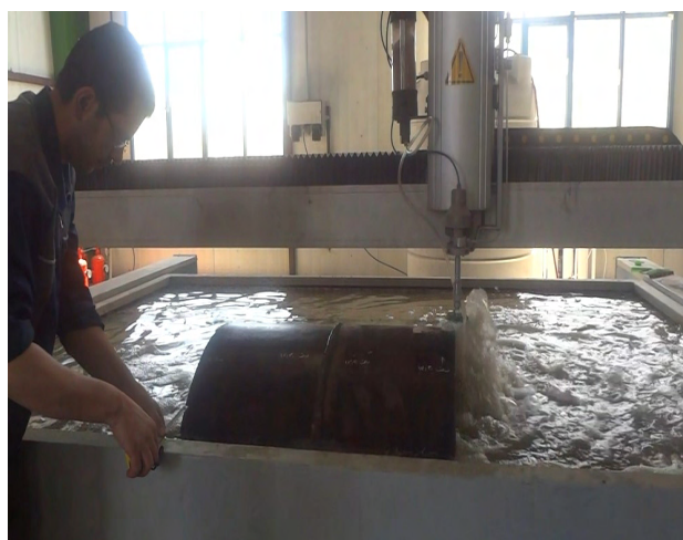
شکل ۶- برشکاری لوله توسط واترجت
