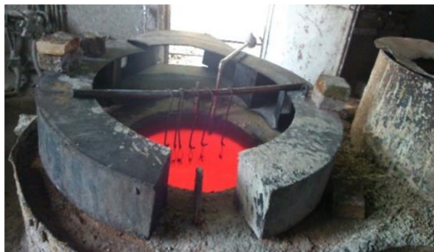
شکل 4- عملیات حرارتی نمونه ها در کوره
