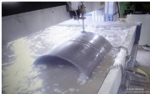
شکل 2- برش لوله توسط واتر جت
