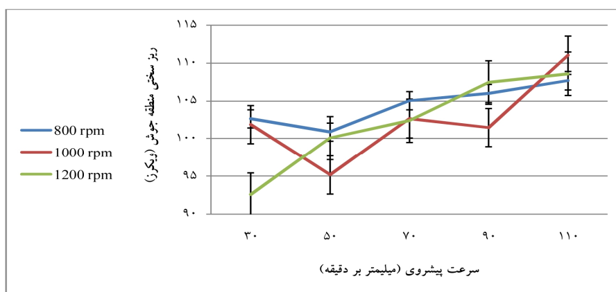
شکل ۱۶- رابطه ریزسختی منطقه جوش با سرعت پیشروی در سرعت های چرخشی ثابت .
