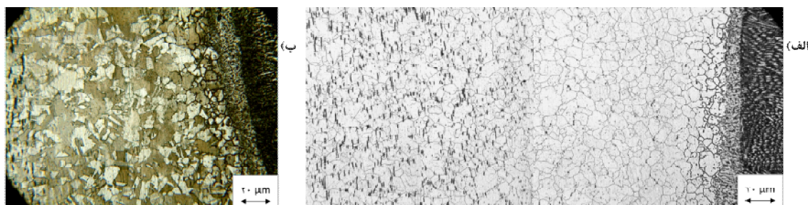
شکل ۱۰- درشت شدن دانه ها در ناحیه HAZ برای جوش MIG2.
