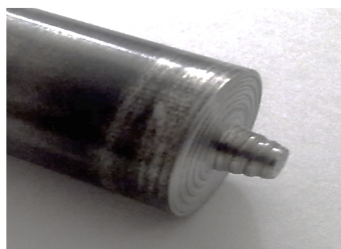
شکل ۲- ابزار طراحی شده جهت جوشکاری اصطکاکی اغتشاشی
