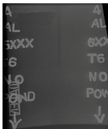
شکل ۴- تصویر رادیوگرافی نمونه جوشکاری اصطکاکی اغتشاشی شده غیر همجنس آلیاژهای آلومینیوم ۵۷۵۴ به ۶۰۶۳؛ الف. با سرعت پیشروی ۴ mm/min و سرعت دورانی ۲۰۰۰ rpm بدون عیب است، ب. با سرعت پیشروی ۸ mm/min و سرعت دورانی ۱۶۰۰ rpm که عیب تونلی در آن مشاهده می‌شود
