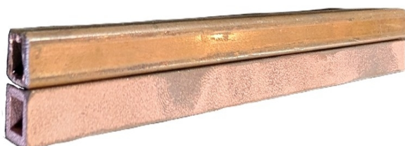
شکل 6- نمونه پرینت سه بعدی در پایین و نمونه اکستروده شده در بالا.
