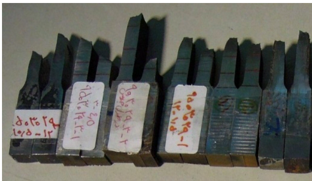
شکل ۱۸- سطح مقطع شکست نمونه‌ها
