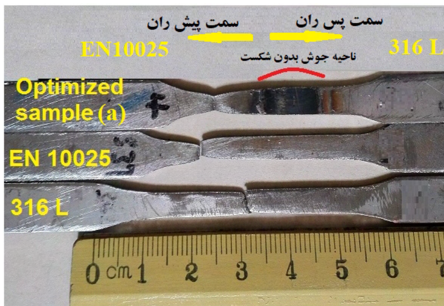
شکل 21- نمونه های آزمایش کشش نمونه بهینه با فلزات پایه.
