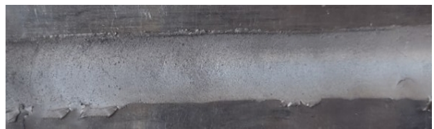
شکل 2- مورفولوژی سطحی جوشکاری اصطکاکی.
