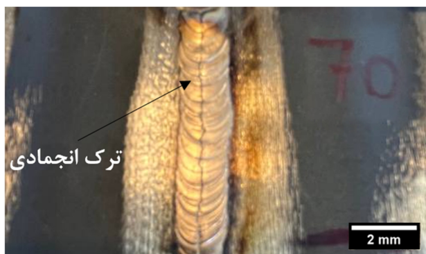
شکل 2- ترک انجمادی در نمونه با جریان 70 آمپر.
