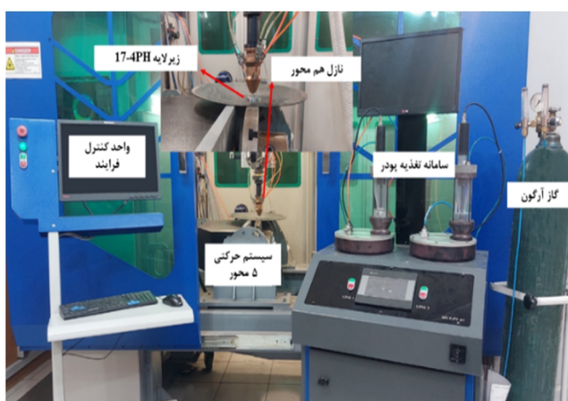
شکل 3- سامانه رسوب‌نشانی مستقیم لیزری آزمایشگاه.
