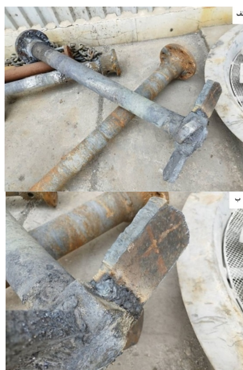
شکل 2- تصاویری از پره‌های همزن مورد مطالعه. الف - نمای کلی از شفت و پره‌های همزن، ب - نمای نزدیک از پره‌ها و شیوه اتصال پره‌ها به شفت.
