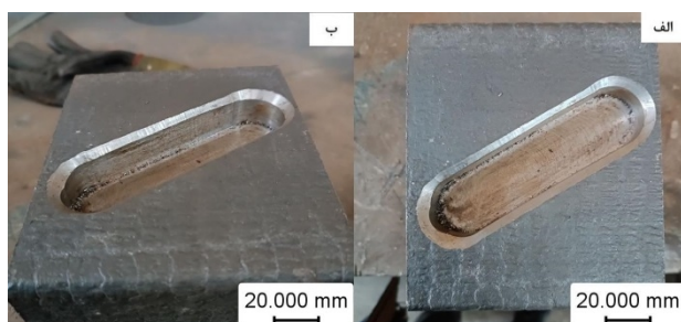
شکل 10- نمای شیار ایجاد شده در ناحیه اتصال پره به شفت.
