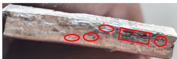
شکل 6- ترک‌های موجود در نمونه قلع-روی 15 پاس.
