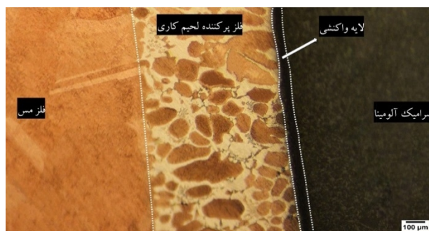
شکل 6- تصویر میکروسکوپی نوری اتصال لحیم کاری آلومینا به مس با فلزپرکننده Ag-Cu-Ti-Sn-3.5Zr.
