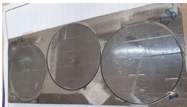
شکل 2- نمونه های دیسکی شکل مورد استفاده در عملیات حرارتی قوسی به قطر 80 میلی متر.
